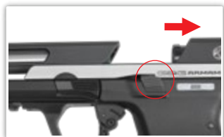
將滑套向後拉並且上推滑套固定桿使其固定於後方
