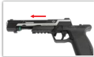
按下滑套固定桿後向前拉出滑套
